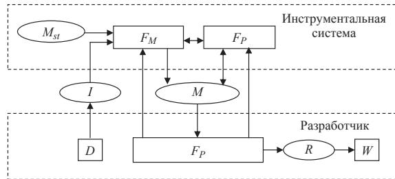
**Рис. 1.** Обобщенная схема разработки ИСППР:  $D$  – процедура сбора информации;  $W$  – процедура реализации решений;  $I$  – исходное описание;  $R$  – решение;  $M$  – модель предметной области;  $M_{st}$  – библиотека типовых моделей;  $F_M$  – процедура сбора информации;  $F_P$  – процедуры принятия решений
