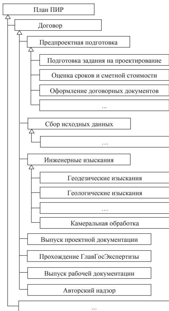
**Рис. 3.** Фрагмент иерархии класса «План проектно-изыскательских работ»
