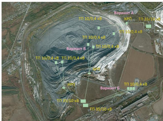
Рис. 1. Конфигурация сети электроснабжения для разных вариантов размещения беспроводных зарядных станций
