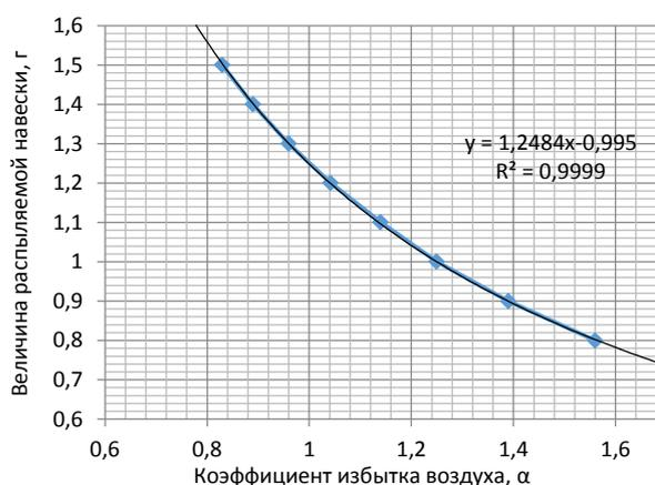
**Рис. 1.** График зависимости величины распыляемой навески в реакционном объеме 4,5 л от коэффициента избытка воздуха  $\alpha$  при средней плотности угля  $1300 \text{ кг/м}^3$
