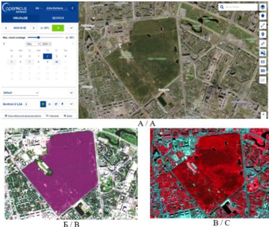
**Рис. 1.** Этапы обработки космоснимков: А) выбор территории и установление необходимых параметров; Б) оцифровка границ парка Сосновка; В) синтез спектральных каналов NIR-Red-Green
