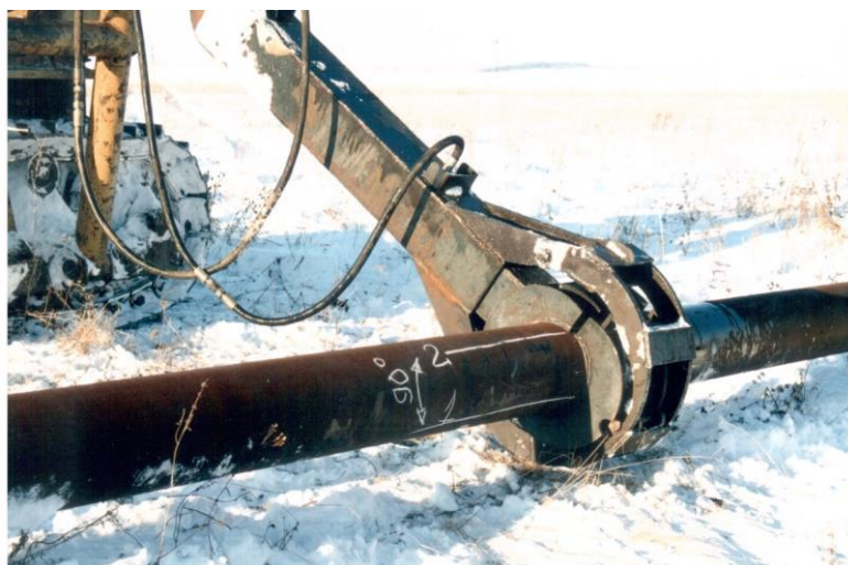
Рис. 4. Схема захватного устройства (а): 1 – корпус; 2 – гидроцилиндр; 3 – стойка корпуса; 4 – шток направляющий; 5, 7 – фрикционные накладки съемные; 6 – затвор замыкающий; 8 – трубопровод. Фотография ЗУ в полевых условиях (б)
