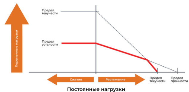
Рис. 3. Предел выносливости [26] Fig. 3. Fatigue strength [26]
