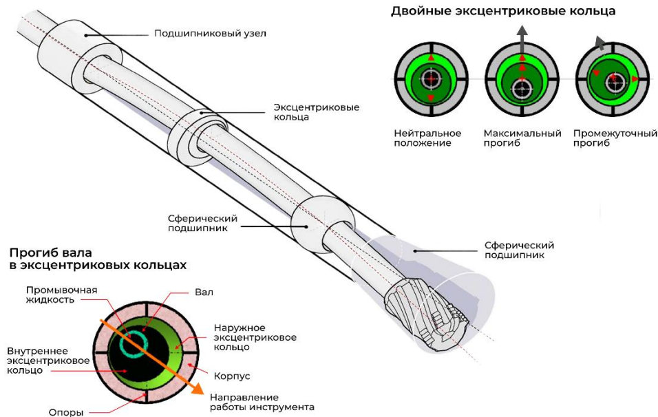
Рис. 2. Роторная управляемая система point the bit [18]
