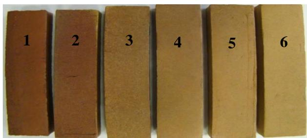
**Рис. 11.** Керамические образцы на основе тёмножгущихся глин с содержанием синтетического волластонита (%): 1 – 0; 2 – 3; 3 – 6; 4 – 9; 5 – 12; 6 – 15
