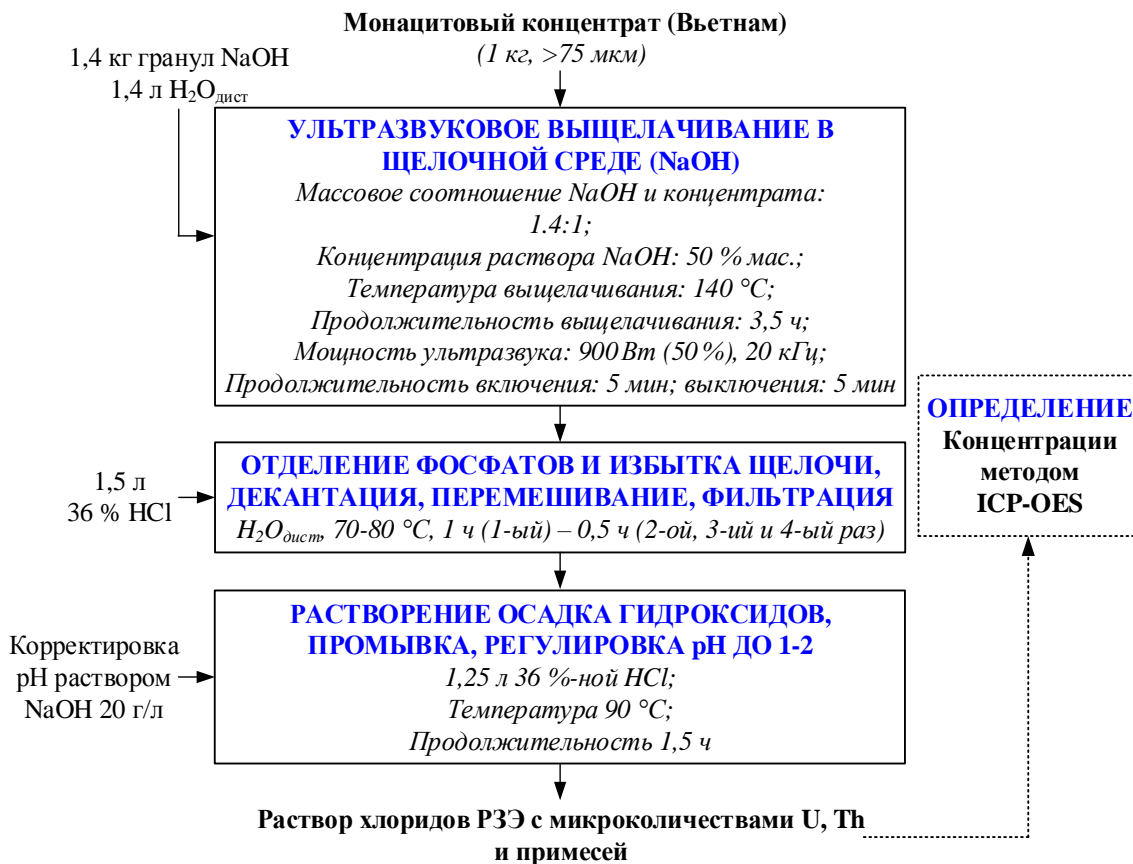
Рис. 11. Схема получения раствора хлоридов РЗЭ Fig. 11. Scheme for the synthesis of a solution of rare earth chlorides
