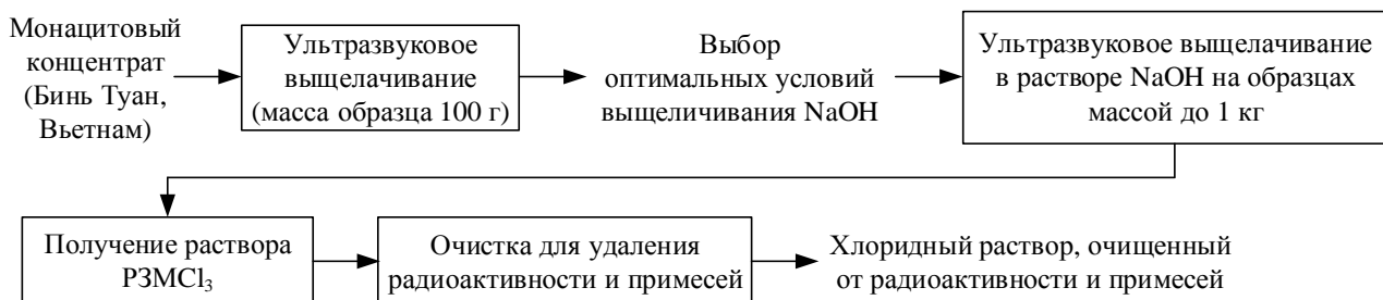
Рис. 1. Методы проведения исследования Fig. 1. Research methods
