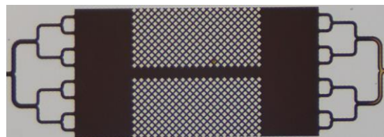
Микрофлюидный чип для моделирования вытеснения нефти через щель между двумя проницаемыми телами
