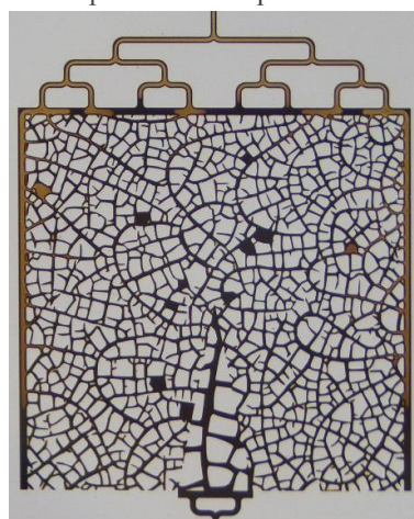
Микрофлюидные чипы для исследования течений в ГРП
