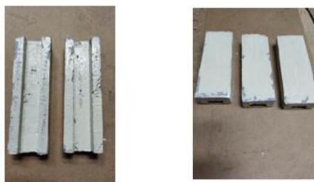
**Рис. 10.** Лабораторные образцы ангидритовых швеллеров размером 240×60×30 мм
