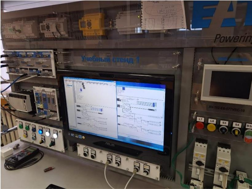
**Рис. 4.** Вычислительная система стенда в составе ПЛК и персонального компьютера
