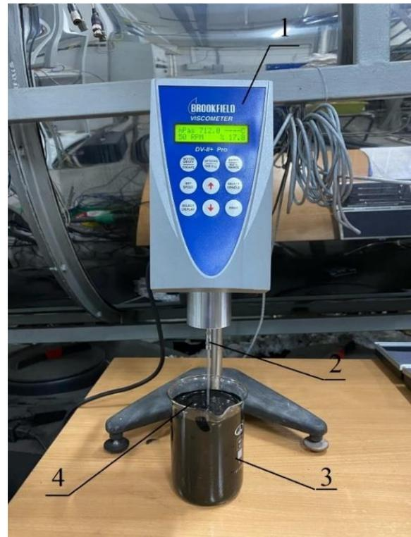
**Рис. 1.** Экспериментальная установка по измерению динамической вязкости ВУС (1 – ротационный вискозиметр; 2 – шпиндель; 3 – цилиндрический стеклянный сосуд с исследуемой суспензией; 4 – Био-ВУС)
