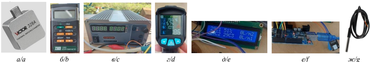
Рис. 9. Приборы и датчики для измерения показателей охлаждения и нагрева ФЭМ: а) инфракрасная камера VIRTOR VC328A 256×192; б) прибор для измерения солнечной радиации TES 1333 SOLAR POWER METER; в) источник постоянного тока GOPHERT CPS-6011 0–60 В 0–11 А; г) пирометр Mestec IR02C; д) плата Arduino UNO; е) датчик температуры и влажности DHT 11; ж) датчики температуры D18B20
