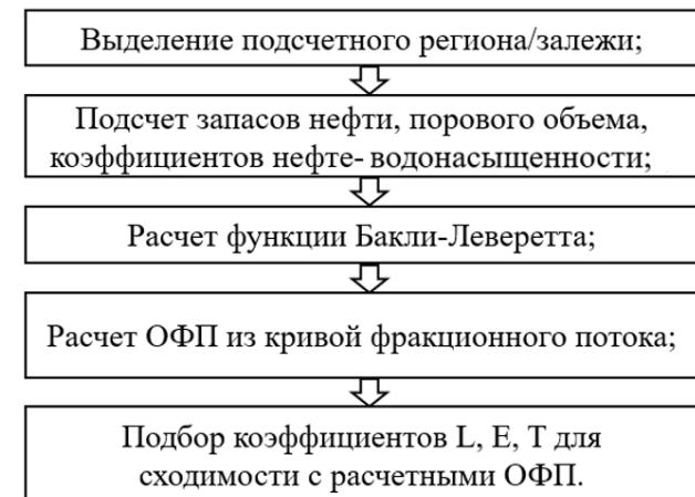
**Рис. 1.** Алгоритм расчета относительных фазовых проницаемостей
