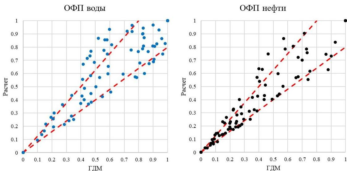
**Рис. 3.** Кроссплоты относительных фазовых проницаемостей для карбонатных коллекторов (красной линией показан интервал 20 % погрешности)
