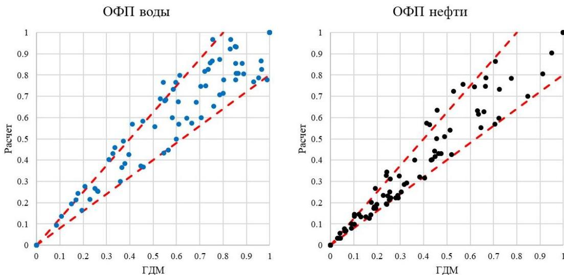
**Рис. 2.** Кроссплоты относительных фазовых проницаемостей для терригенных коллекторов
