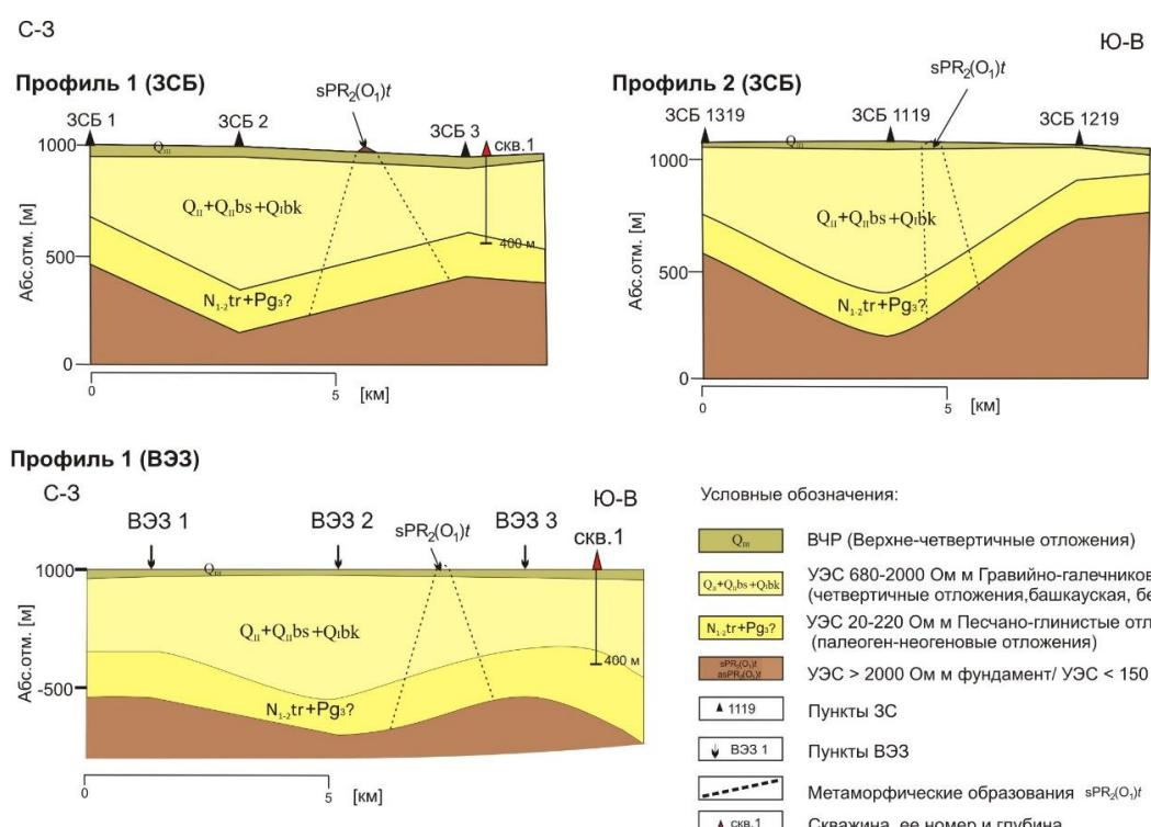
Рис. 5. Геоэлектрические разрезы по профилям ЗСБ и ВЭЗ (западная часть Уймонской впадины)
