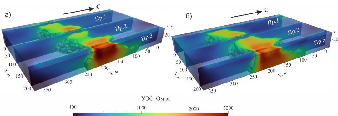
**Рис. 4.** Результат 3D-инверсии модельных данных, выделен объем среды, с диапазоном УЭС > 900 Ом·м: а) модель 1; б) модель 2
