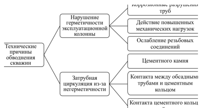
Рис. 2. Технические причины обводнения скважин
