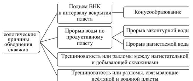
Рис. 3. Геологические причины обводнения скважин
