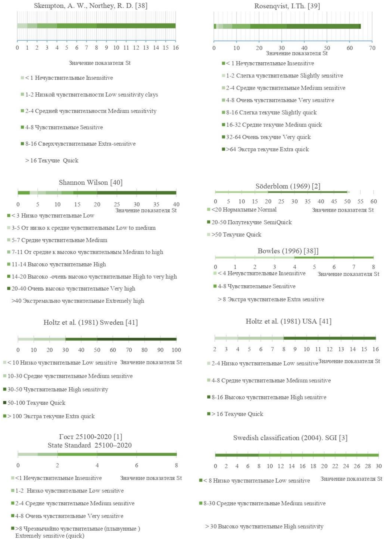
Рис. 1. Классификации грунтов по показателю чувствительности S_t (кПа) Fig. 1. Classification of soils by sensitivity S_t (kPa)
