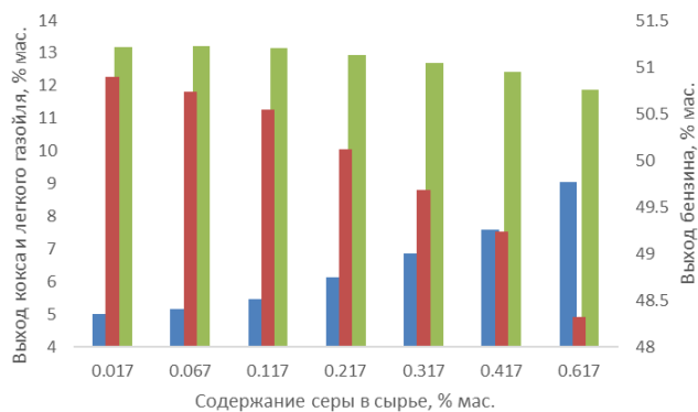
Рис. 6. Зависимость выхода продуктов крекинга от содержания серы в сырье процесса (расчеты по модели)
