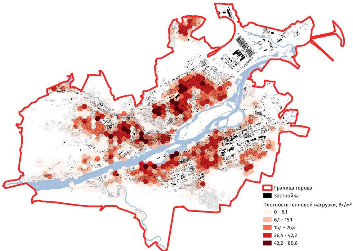
Рис. 9. Удельная тепловая нагрузка
