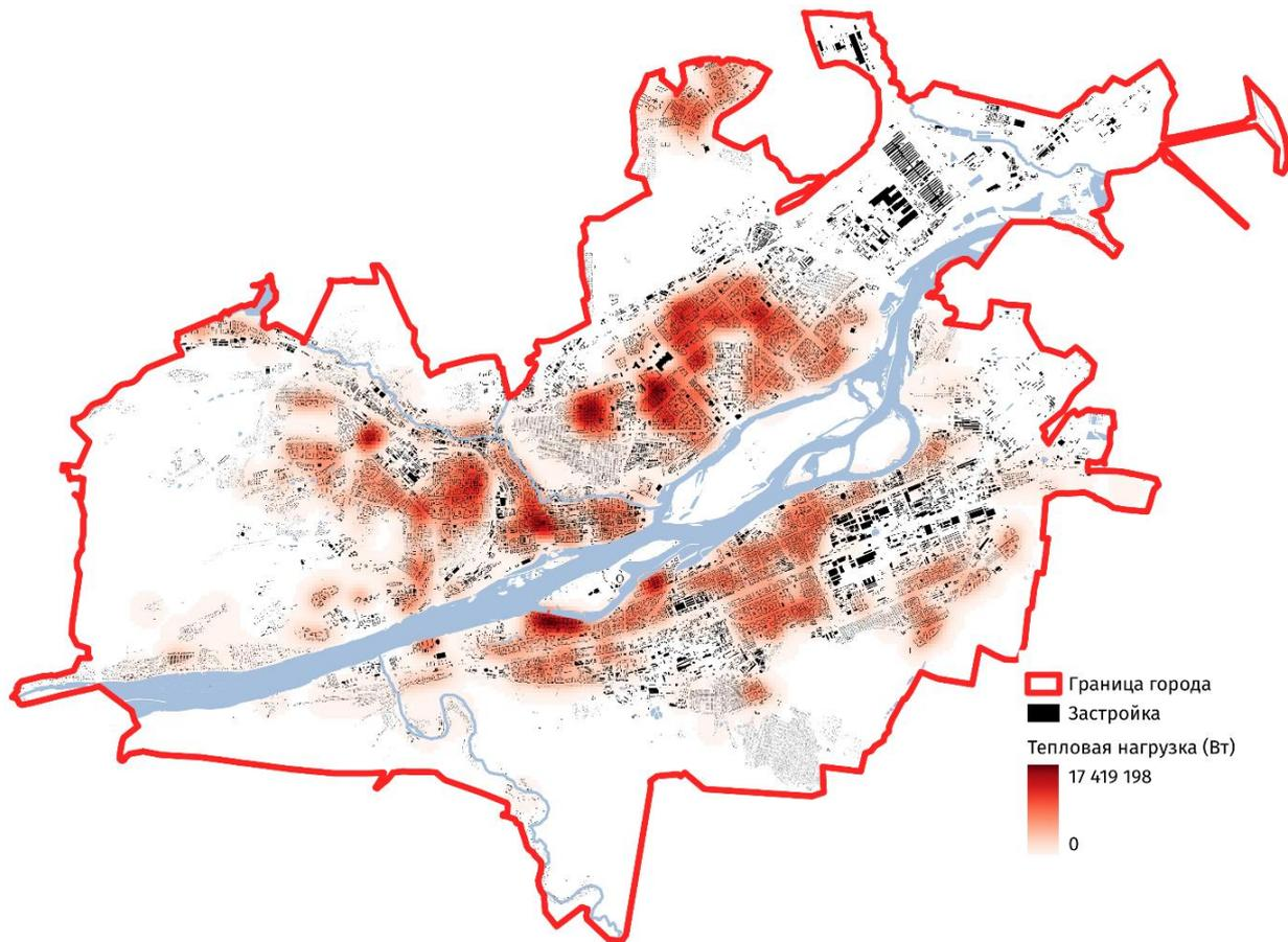
**Рис. 8.** *Распределение тепловой нагрузки многоквартирного жилого фонда*
