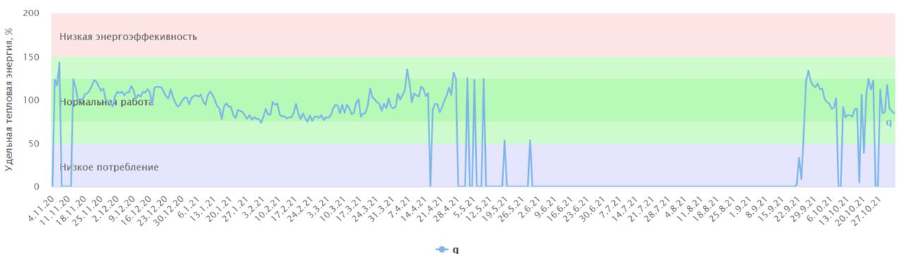
**Рис. 7.** График относительного удельного теплопотребления системы альтернативного здания
