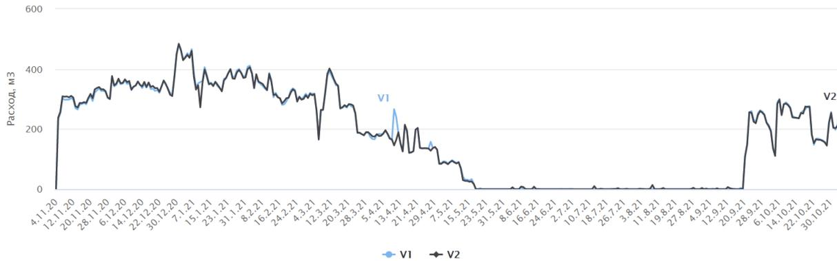
**Рис. 4.** График расхода теплоносителя рассматриваемой системы здания
