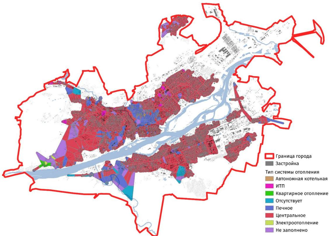
Рис. 10. Распределение систем теплоснабжения
