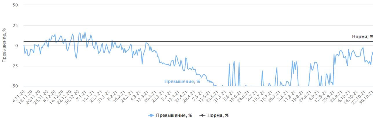
**Рис. 3.** График превышения температур теплоносителя обратного трубопровода рассматриваемой системы здания
