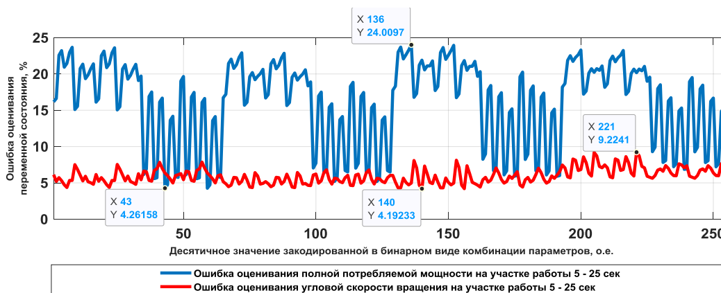
Рис. 8. Результаты полного факторного эксперимента при исследовании ошибки оценивания угловой скорости вращения АД (красная) и полной потребляемой мощности (синяя) при изменении параметров на участке работы 5–25 с
