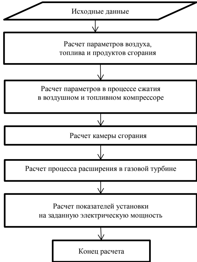
Рис. 2. Блок-схема расчета КГПУ Fig. 2. Block diagram of contact gas-steam installation calculation
