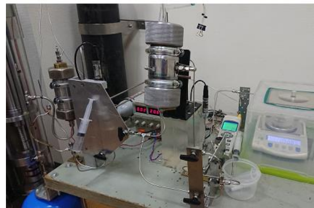
Рис. 2. Принципиальная схема и фото экспериментальной установки: 1 – исследуемый образец в кернодержателе; 2 – гидроаккумулятор; 3 – датчик порового давления; 4 – клапан для выравнивания давления; 5 – весы для измерения массы жидкости, прошедшей через образец; 6 – точка инъекции газа; 7 – пузырёк газа поступает по трубке в образец
