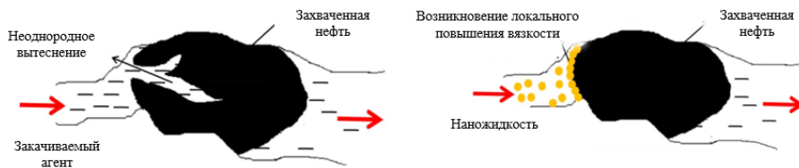
Рис. 5. Принципиальная схема различия фильтрации нефти в коллекторе под действием воды и наножидкости [18] Fig. 5. Schematic diagram of the difference between oil filtration in the reservoir under the action of water and nanofluid [18]
