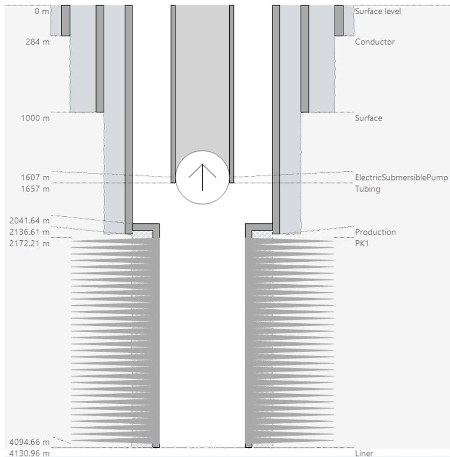
**Рис. 3.** Конструкция скважины № 1 Северо-Комсомольского месторождения
