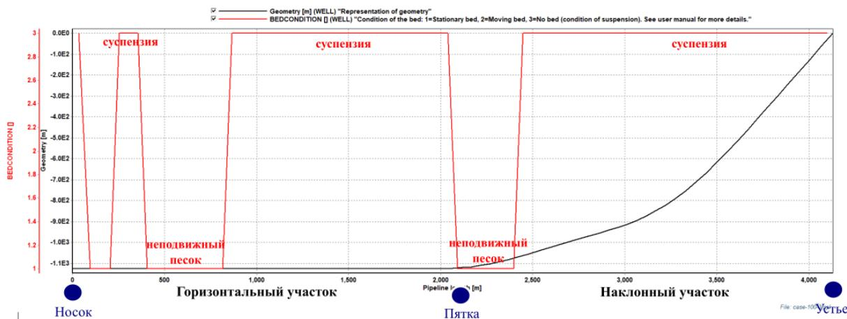
**Рис. 7.** Режим движения песка диаметром 69 мкм при дебите скважины 164 м<sup>3</sup>/сут. (обводнённости 70 %)
