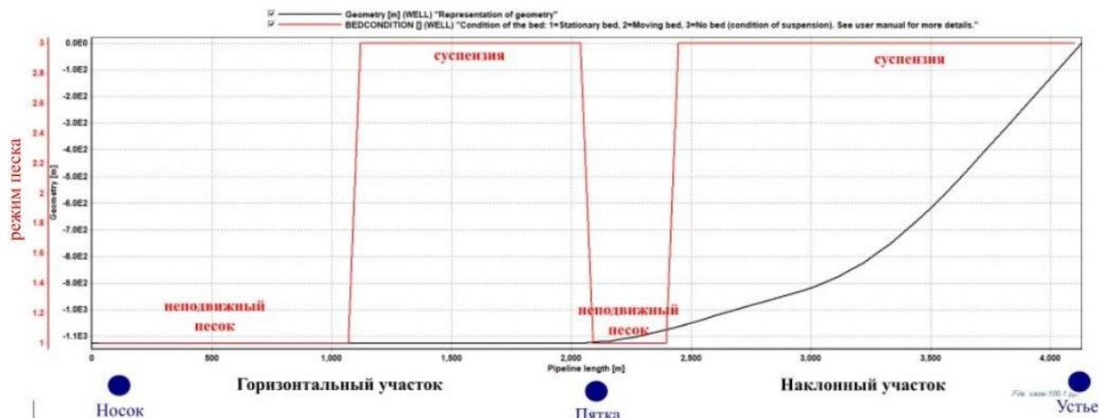
**Рис. 5.** Режим движения песка диаметром 72 мкм при дебите скважины 115 м<sup>3</sup>/сут.
