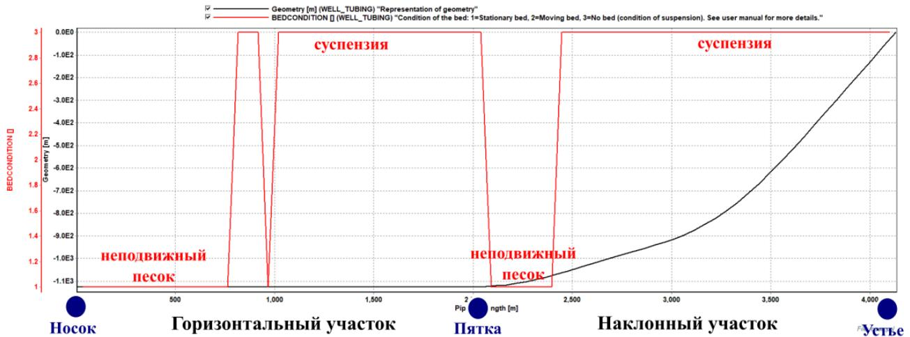
**Рис. 8.** Режим движения песка диаметром 70 мкм при дебите скважины 177 м³/сут. (обводнёность 90 %)
