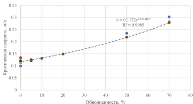
**Рис. 13.** Зависимость критической скорости от объёмной доли воды
