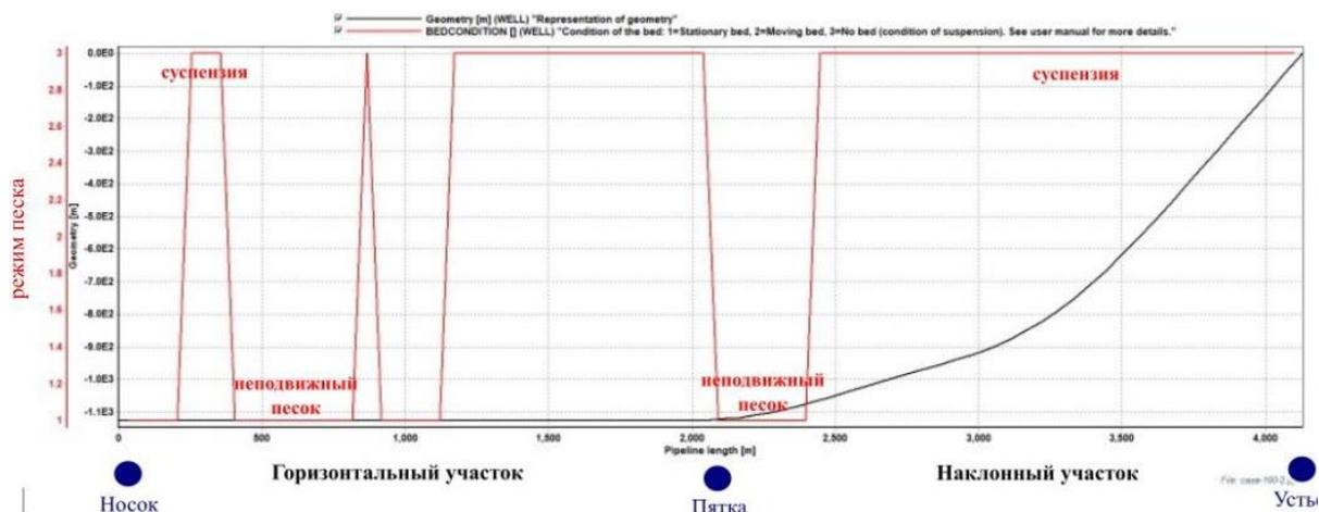
**Рис. 6.** Режим движения песка диаметром 100 мкм при дебите скважины 121 м<sup>3</sup>/сут. (обводнённости 50 %)
