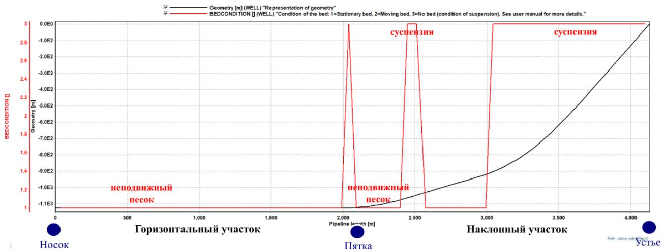
**Рис. 9.** Режим движения песка с диаметром 45 мкм при дебите скважины 71 м³/сут. (газовый фактор=100 м³/т)
