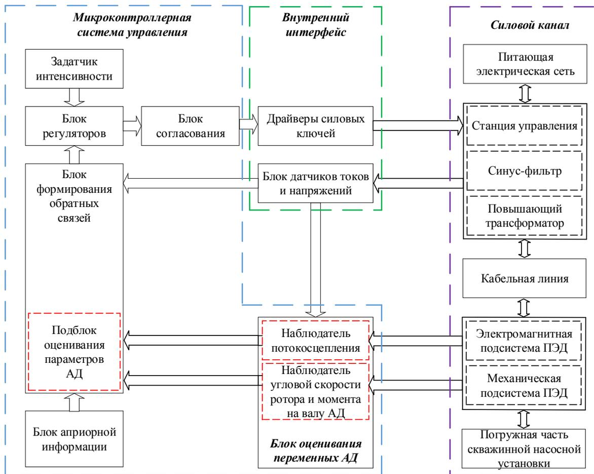
Рис. 5. Электромеханическая система с регулируемым асинхронным двигателем и косвенным методом измерения переменных состояния
