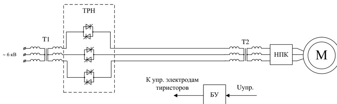
**Рис. 2.** Принципиальная схема разомкнутой системы электропривода УЭЦН с тиристорным регулятором напряжения (ТРН): НПК – длинный нефтепогружной кабель; БУ – блок управления тиристорным регулятором напряжения (ТРН)
