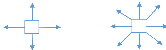
Рис. 4. Принципы связности точек в дискретном случае: четырехсвязность (слева) и восьмисвязность (справа)
