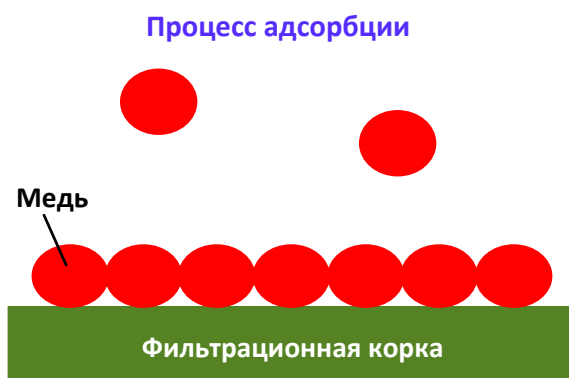
Рис. 1. Адсорбция меди на поверхности фильтрационной корки
