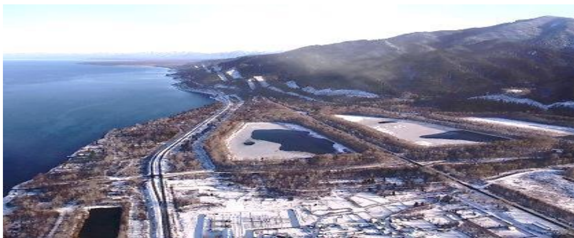
Рис. 1. Солзанский полигон ОАО «Байкальский ЦБК» для складирования лигнинсодержащих осадков (более 6 млн м 3 ) Fig. 1. Solzansky landfill of Baikalsky Pulp and Paper Mill for storage of lignin-containing sediments (more than 6 million cubic meters)
