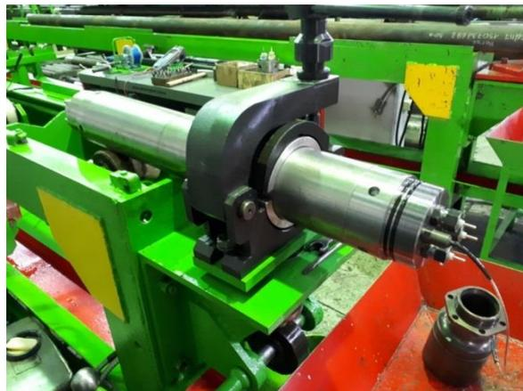
Рис. 1. Опытный образец внутрискважинного компенсатора реактивной мощности
