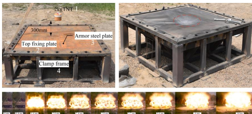
Рис. 5. Испытания стальной пластины на действие воздушного взрыва: 1 – заряд 2 кг тротила; 2 – верхняя крепежная пластина; 3 – броневая стальная пластина (экспериментальный образец); 4 – зажимная рама
