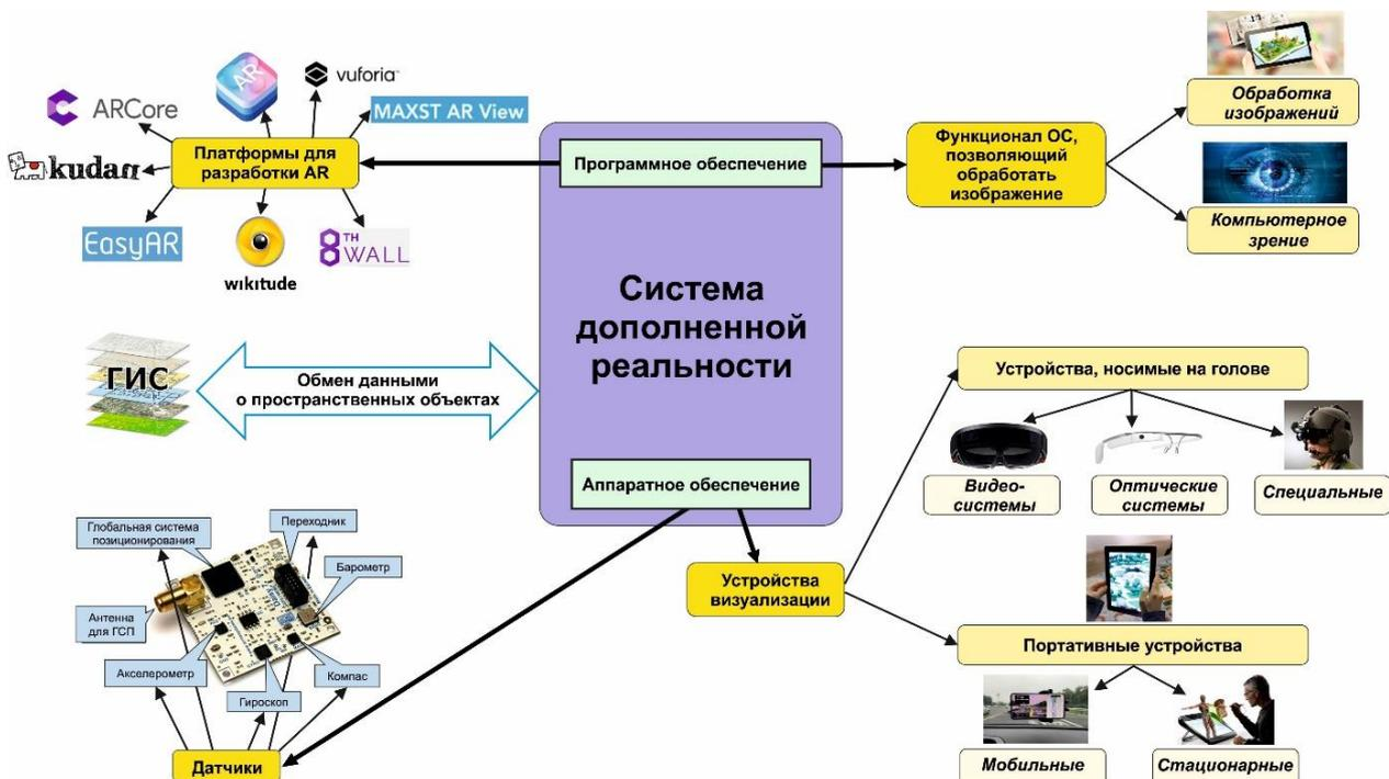
Рис. 1. Структура аппаратно-программного комплекса системы дополненной реальности в картографии и геоинформатике
