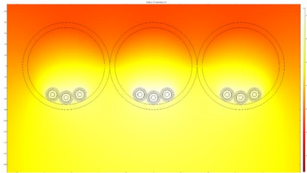
Рис. 3. Температурное поле кабеля с алюминиевыми жилами и близлежащего грунта после корректировки (эксперимент 3)
