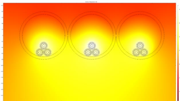
Рис. 4. Температурное поле кабеля с алюминиевыми жилами (треугольник) и близлежащего грунта после корректировки (эксперимент 4)
