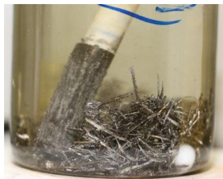
Рис. 6. Процесс очистки катода от осадка урана Fig. 6. Cathode purification from uranium deposit
