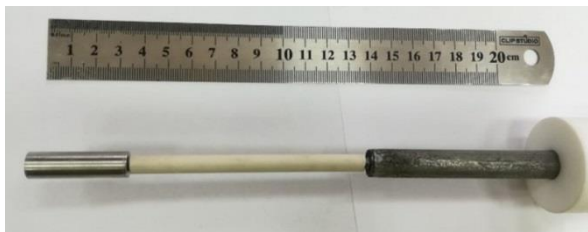
Рис. 4. Фотография катодной сборки (катод – слева) Fig. 4. Photo of the cathode assembly (the cathode is on the left)
