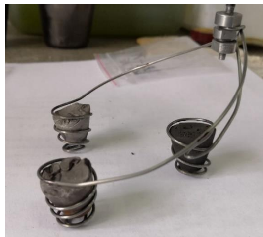
Рис. 3. Молибденовая корзина с загруженными образцами
