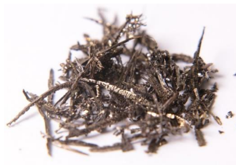
Рис. 7. Очищенный катодный уран Fig. 7. Purified cathodic uranium
