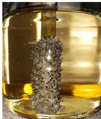
Рис. 5. Катод с осадком урана, помещенный в раствор азотной кислоты
