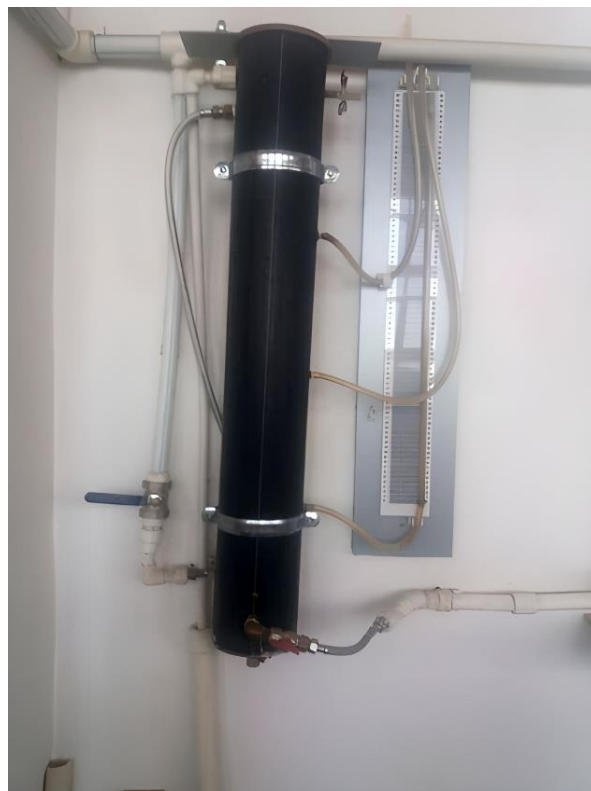
Fig. 1. Laboratory installation of a frame-filling filter Рис. 1. Лабораторная установка каркасно-засыпного фильтра (КЗФ)
