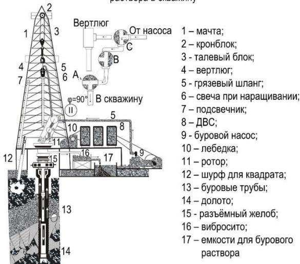
Рис. 6. Общий вид и конфигурация системы непрерывной промывки при наращивании бурового става
