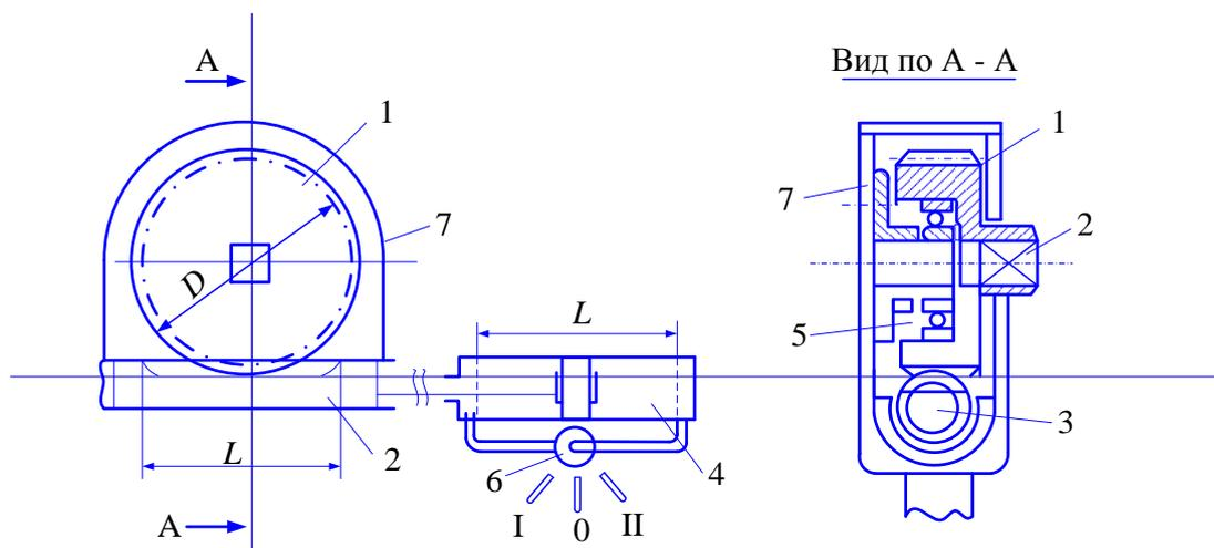
**Рис. 4.** Зубчато-реечный переключатель кранов: 1 – зубчатое колесо ( $m=8, z=38$ ), 2 – поворотный квадрат; 3 – зубчатая рейка ( $m=8, z=10$ ); 4 – гидроцилиндр ( $L=250$  мм); 5 – шариковый подшипник; 6 – гидрораспределитель двухпозиционный; 7 – кожух
