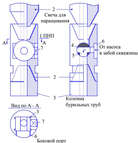
**Рис. 1.** Переводник непрерывной промывки при наращивании буровой колонны: 1 – корпус; 2 – верхняя и нижняя замковая резьба; 3 – крановый цилиндр, имеющий сквозной осевой – 4 и перпендикулярно к нему боковой – 5 канал; 6 – боковой порт; 7 – поворотный квадрат переходника непрерывной промывки (ПНП)
