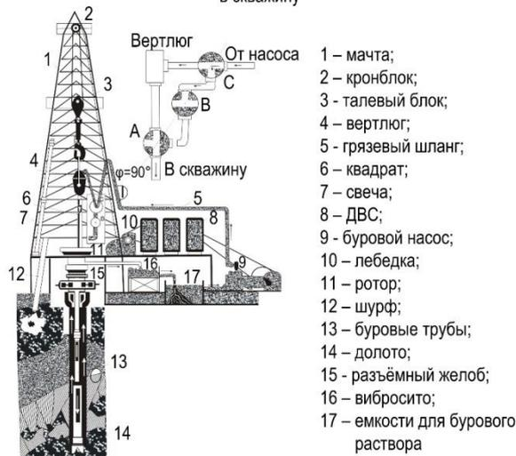
Рис. 5. Общий вид буровой установки при бурении и прямой подаче бурового раствора в скважину
