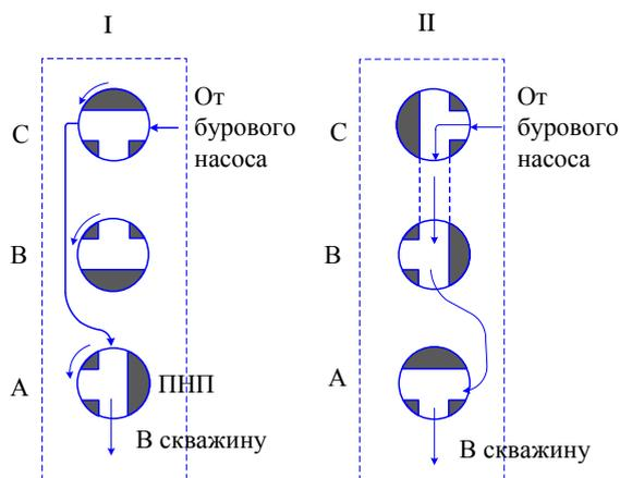
**Рис. 3.** Положение крановых каналов при: I – прямая подача бурового раствора в скважину (исходное положение); II – боковая подача бурового раствора в скважину (при синхронном повороте кранов ABC на 90°); ПНП – переводник непрерывной промывки
