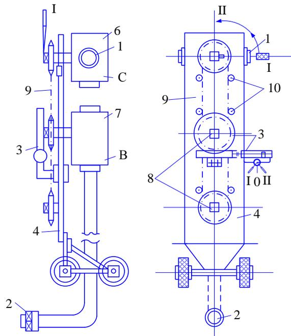
**Рис. 2.** Передвижной синхронизатор переключения (ПСПК) кранов (А, В, С): 1 – порт присоединения основной линии промывки; 2 – байпасная линия промывки; 3 – зубчато-реечный переключатель кранов; 4 – рычаг ручного переключения кранов (запасной); 5 – панель; 6 – корпус крана С; 7 – корпус крана В; 8 – поворотные квадраты кранов; 9 – приводная цепь; 10 – натяжные ролики цепи
