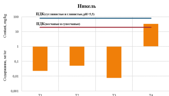
Рис. 8. Сравнение концентраций Zn и Ni в осадке с ПДК для почв по СанПиН 1.2.3685-21
