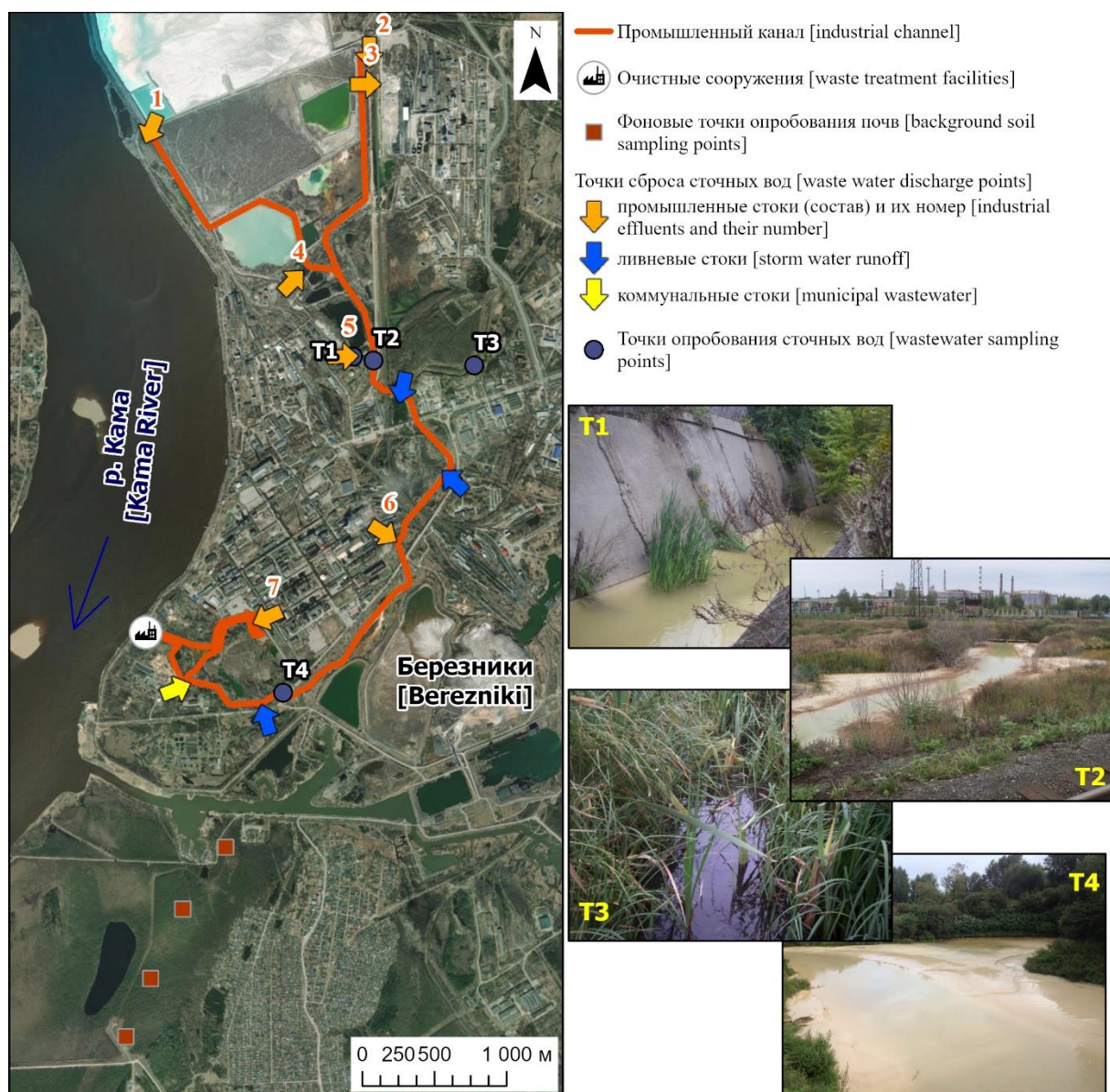
Рис. 2. Современное расположение промканала г. Бerezники, положение точек поступления сточных вод и точек отбора проб; T1, T3 – фото точек опробования в коллекторах сбора сточных вод с прилегающей к каналу территории; T2, T4 – фото точек опробования в канале
