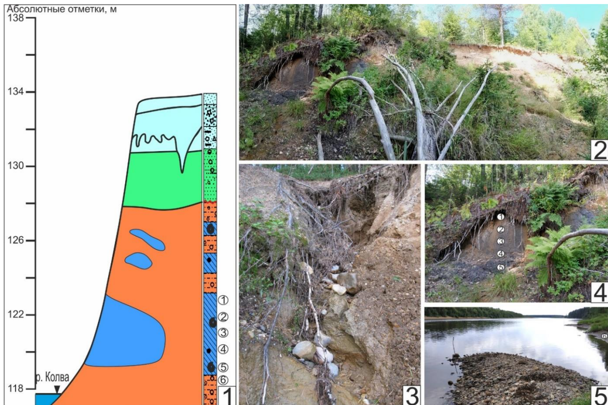
Рис. 2. Разрез Вильгорт. Зарисовка поперечного профиля разреза Вильгорт по результатам исследований предшественников [19] и полевым наблюдениям авторов настоящего исследования (1) (условные обозначения литологии – на рис. 4); цифрами в кружках показаны места отбора проб. Общий вид на разрез (2). Выходы супеси и песков с кварцевой галькой и щебнем, слои 12–14 (3). Выходы черных глин и аргиллитов с мезозойской фауной, эрратические отложения, с точками отбора проб (4). Берег реки Колвы у подножья разреза с точкой отбора проб у уреза воды (5)
