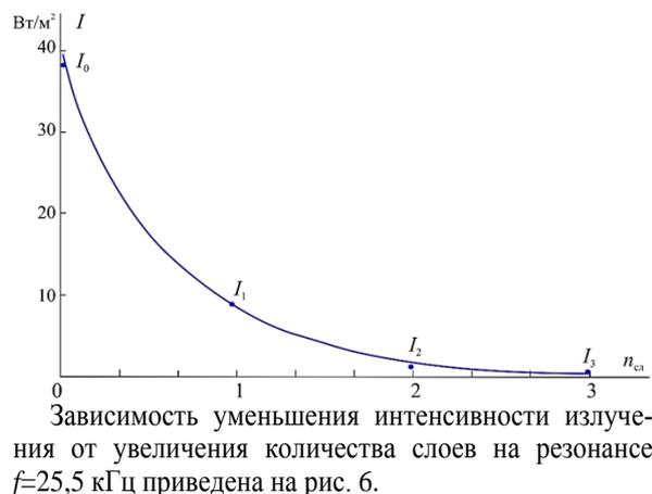
**Рис. 6.** Зависимость уменьшения интенсивности излучения от увеличения количества слоев при резонансе  $f=25,5$  кГц
