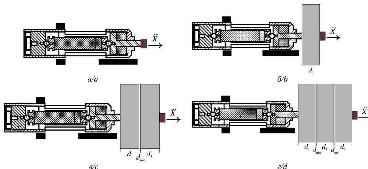
Рис. 3. Виды акустических систем: а) режим КЗ; б) нагрузка в виде одного слоя ПММА; в) нагрузка в виде двух слоев ПММА; г) нагрузка в виде трех слоев ПММА
