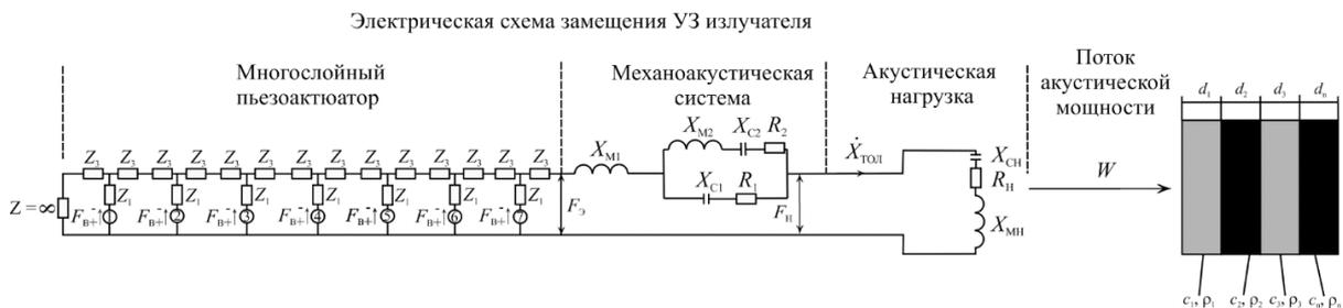
Рис. 2. Электрическая схема замещения УЗ излучателя резонансного типа
