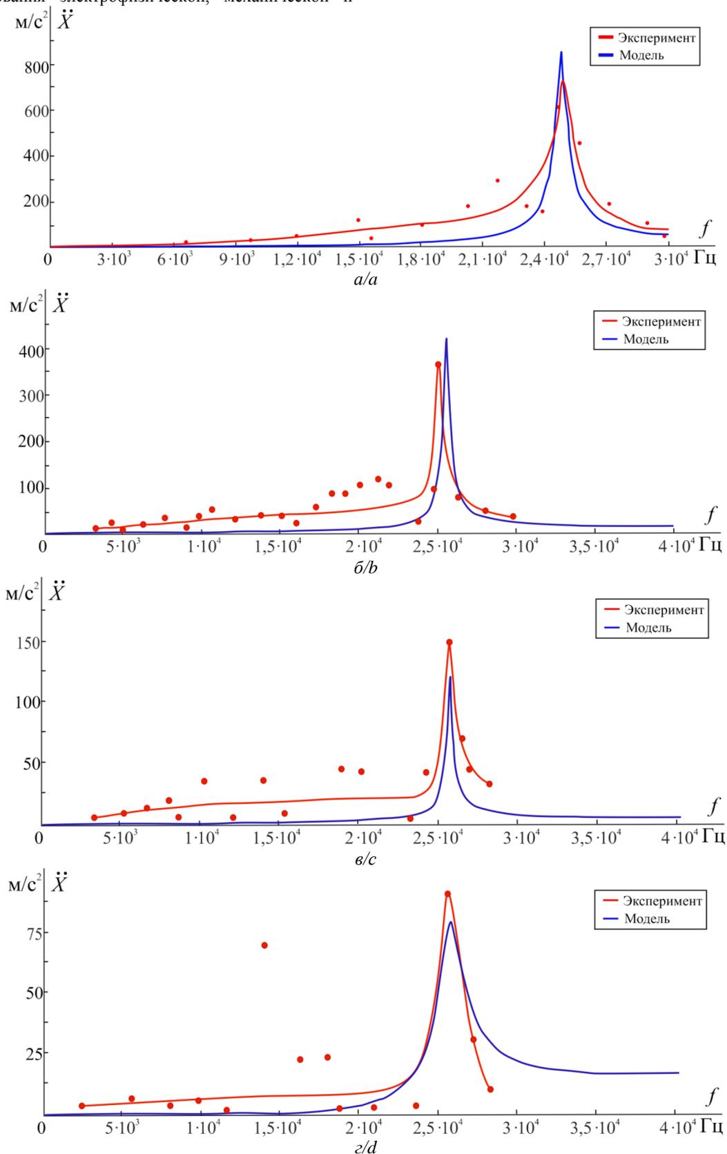
**Рис. 4.** АЧХ ускорения УЗ излучателя резонансного типа, сравнение данных расчета и эксперимента для случая: а) колебательная система УЗ излучателя с учетом зоны контакта толкателя УЗ излучателя с поверхностью слоя; б) один слой; в) два слоя; г) три слоя
