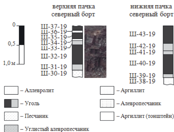
Рис. 2. Опробование угольных пластов бороздовым методом
