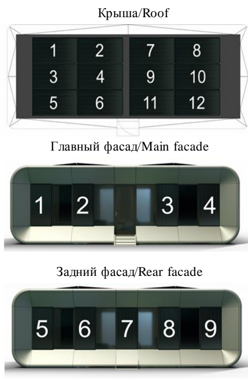
Рис. 1. Планы крыши и фасадов модульного дома с предполагаемыми местами размещения солнечных панелей
