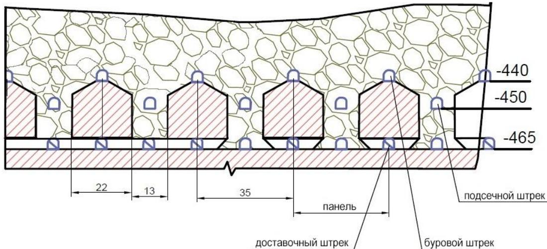
Рис. 5. Вариант системы разработки с обрушением руды, рудник «Удачный» [55]
