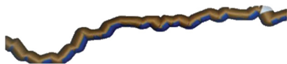
Рис. 1. Схематический профиль трубопровода со скоплениями воды
