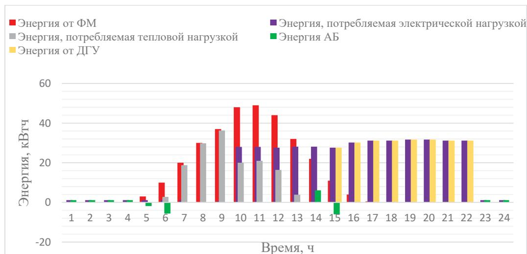
**Рис. 5.** Диаграмма энергетического баланса в условиях зимней нагрузки
