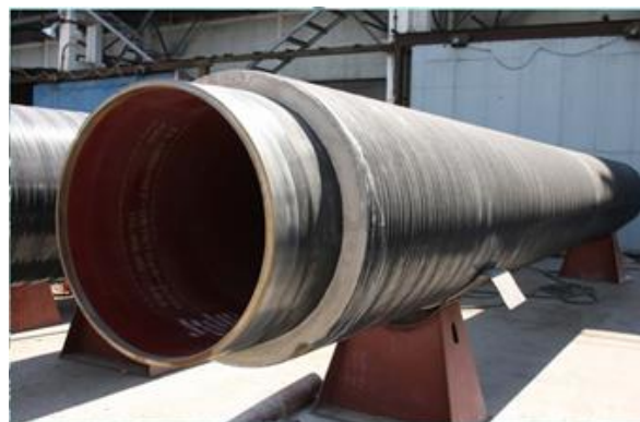
Рис. 2. Внешний вид обетонированной трубы
