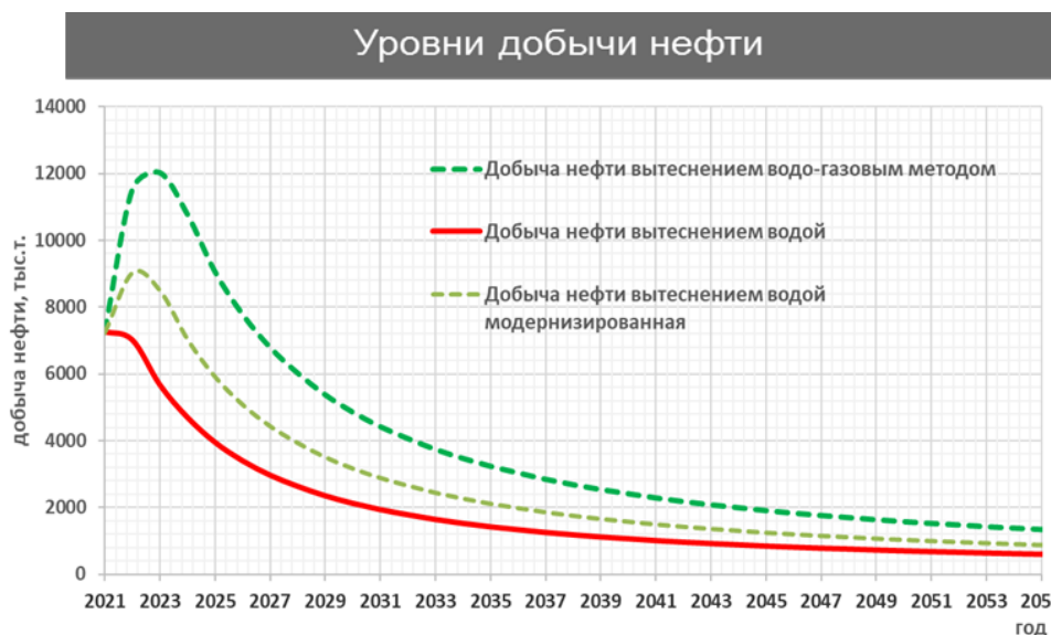
Рис. 3. Изменение уровней добычи нефти при модернизации системы ППД
