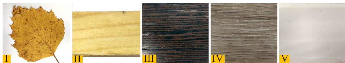
Рис. 1. Типичные горючие материалы: I – лист березы; II – древесина; III – ламинированная древесно-стружечная плита (ДСП); IV – линолеум; V – поливинилхлорид (ПВХ)
