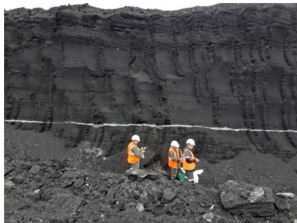
Рис. 2 Фотография тонштейна в угольном пласте Fig. 2. Photograph of the tonstein within the coal seam
