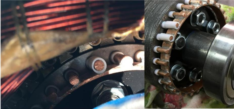
**Рис. 5.** Обрыв стержней ротора асинхронного двигателя – одного стержня, двух стержней
