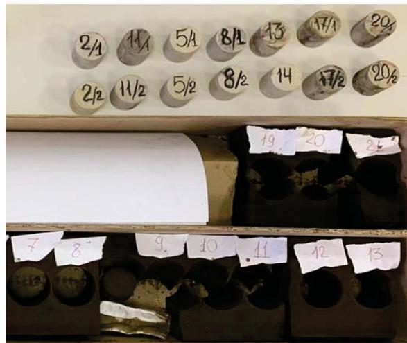
Рис. 1. Фотография исходного керна и образцов керна, подготовленных для испытаний
