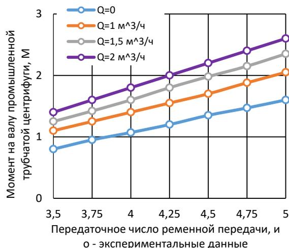
Рис. 1. Расчетные зависимости момента  $M$  на валу промышленной трубчатой центрифуги ОТР-151К-01 при ее работе на воде от передаточного числа  $u$  и привода при различной производительности  $Q$  (частота вращения вала двигателя 2900 об/мин)
